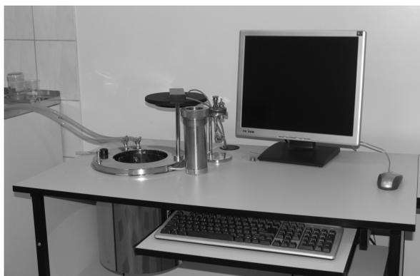
Fig. 5. Calorimeter KL-12 of Bit-Precyzja firm
